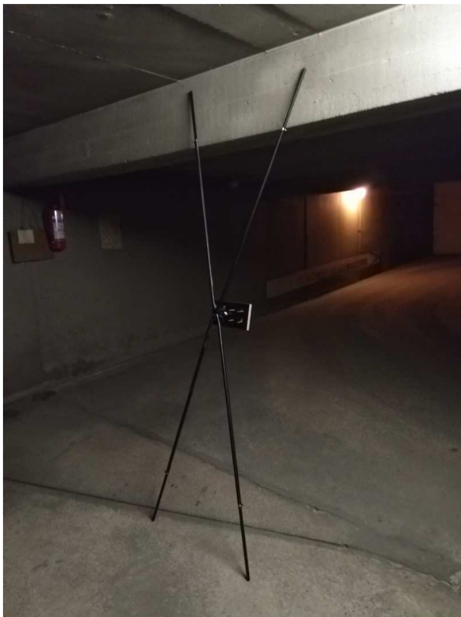
Improvisoitu VHF I ... VHF II adjustable X-wing/Bow-tie
