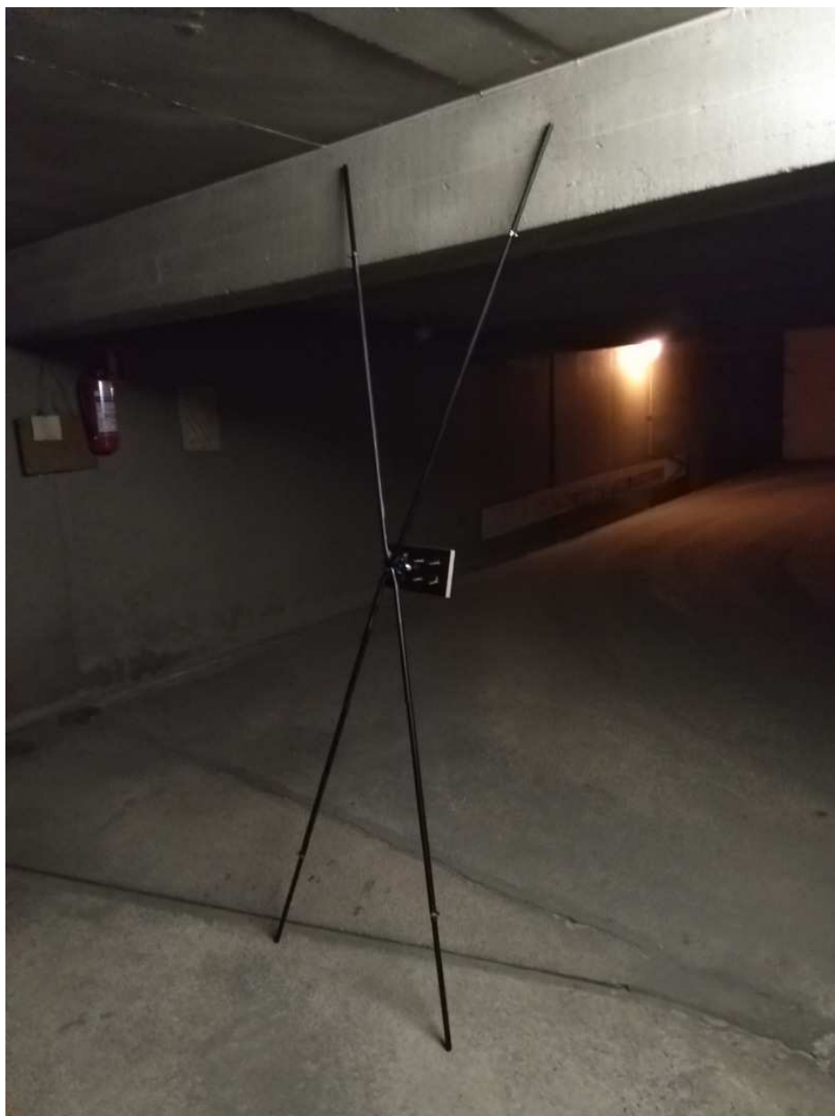
Improvisoitu VHF I ... VHF II adjustable X-wing/Bow-tie
